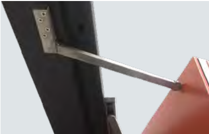
双开门顺序器 - 确保关门时先关闭固定扇 常开 必选 常闭 必选
