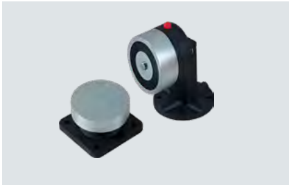
电磁门吸 - 日常维持门体开启，火警时断电释放 常开 必选 常闭 不可选
